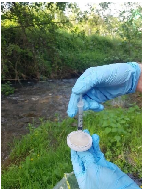
Слика 14 - Узимање узорка еДНК из речних токова
